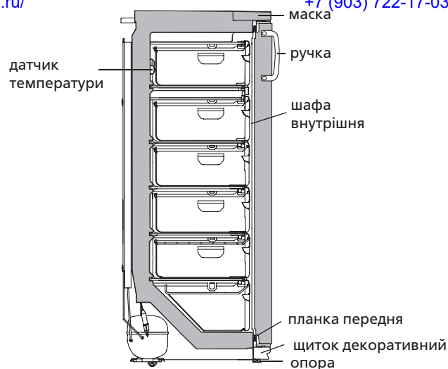
Рисунок 5 – Схема морозильника
